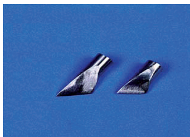
7. attēls. PG 200 iekārtas zondes asmens: kreisajā pusē – atbilstošs, labajā – stipri nolietots.
